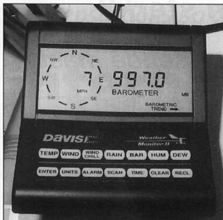
De Davis Weather Monitor II. Het kloppend hart van het 'DTMX' systeem. De X staat voor eXperimenteel. DTMF zijn de toontjes waarmee het systeem via de radio kan worden aangesproken.
